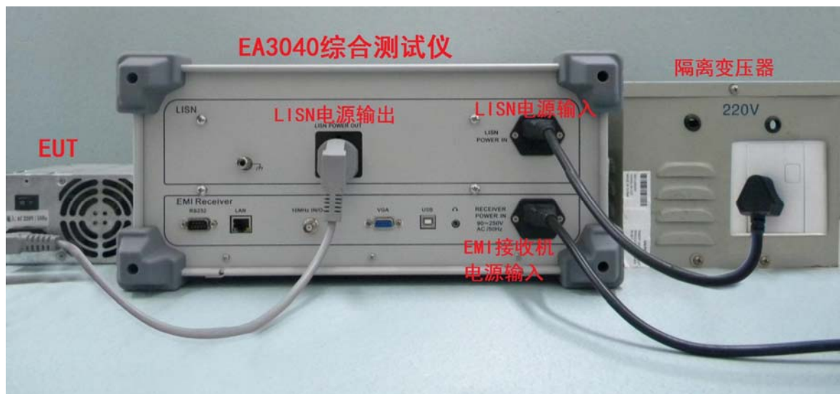
图 4.7 CE102 传导测试实例连接图
